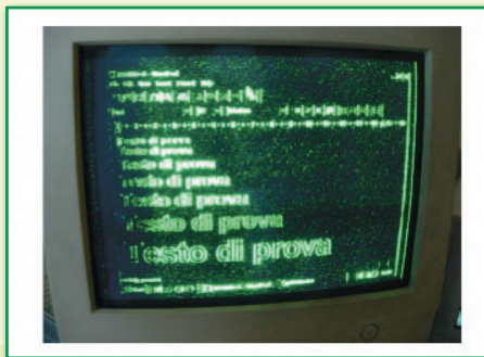
▼ Alcuni esempi di lettura remota tramite cannone laser.
